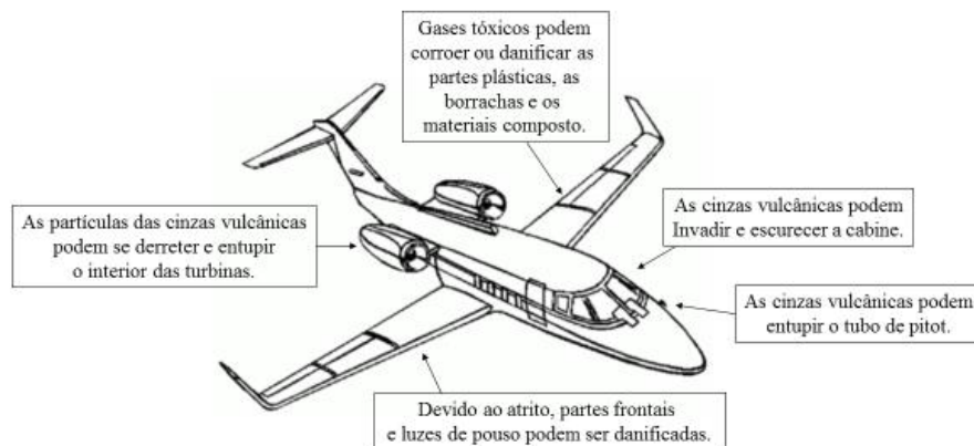
Figura 3 - Danos gerais na aeronave provocados por cinzas vulcânicas
